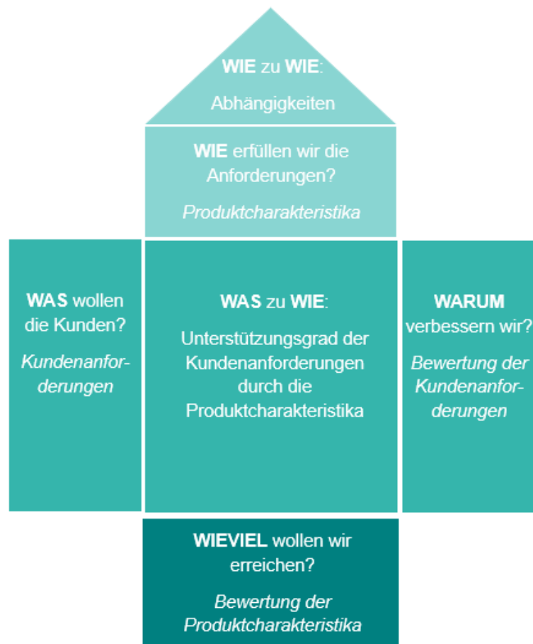
Abbildung 1: Eigene schematische Darstellung des HoQ nach (Dr. rer.pol. Herzworm 1998)
