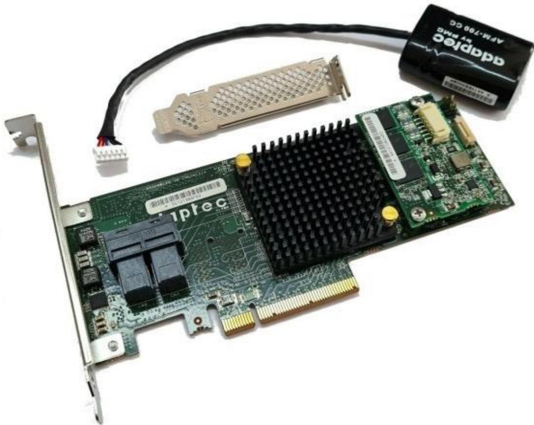
Abbildung 5: RAID-Controller mit BBU-Unit (Haehnlein-IT 2024)
