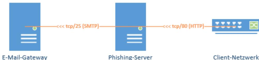
Abbildung 10 - Netzwerkkonfiguration. Quelle: Autor
