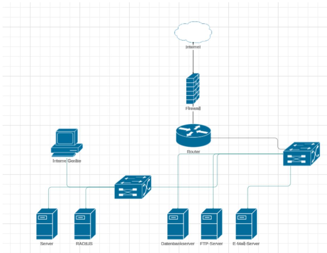
Diese Skizze soll einen sehr einfachen Aufbau eines Netzwerkes darstellen – mit den üblichen notwendigen Komponenten sei es in diesem Fall Clients, Server, Switche, Router oder Firewalls.
