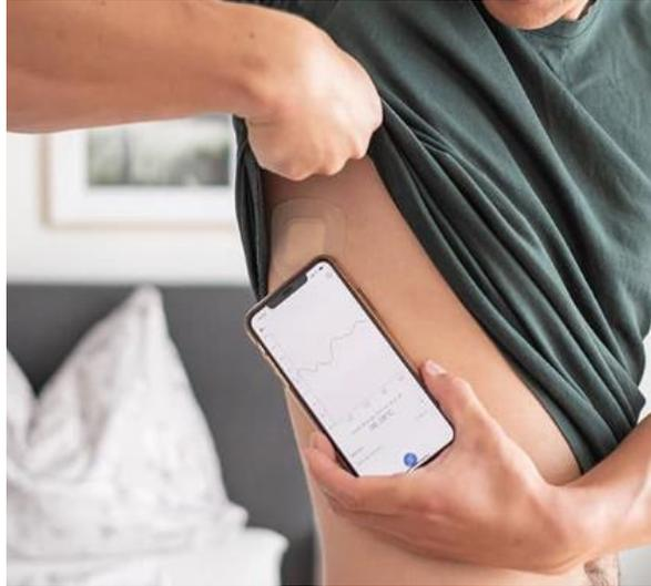
Abbildung 26: NFC Übertragung SteadyTemp®
