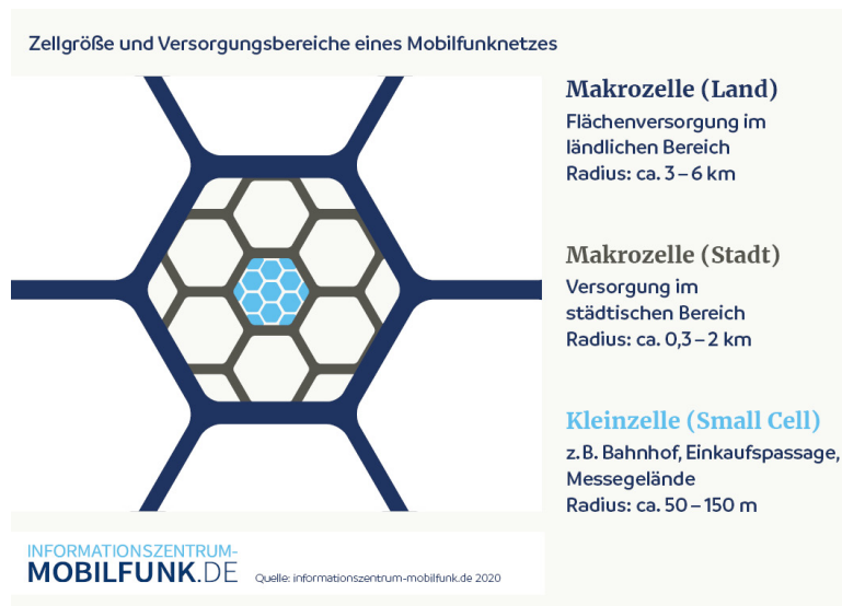
Abbildung 2.6: Darstellung von Mobilfunkzellen. Quelle: informationszentrum-mobilfunk.de
