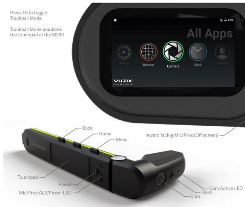
Abbildung 5 - Vuzix M300 Display und Bedienung Quelle: (Vuzix Cooperation, 2018)
