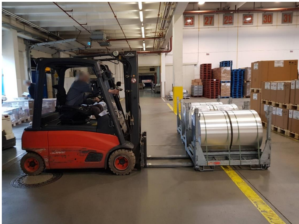
Abbildung 20 - Barcode scannen vom Stapler aus
