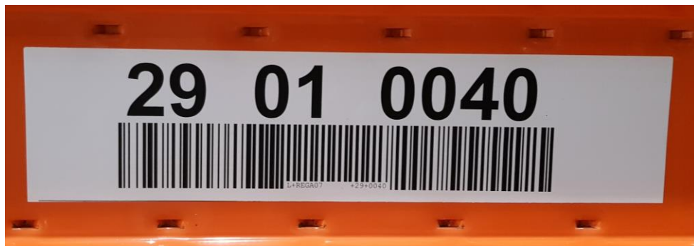
Abbildung 10 - Beispiel für die Kennzeichnung eines Regal-Lagerplatzes
