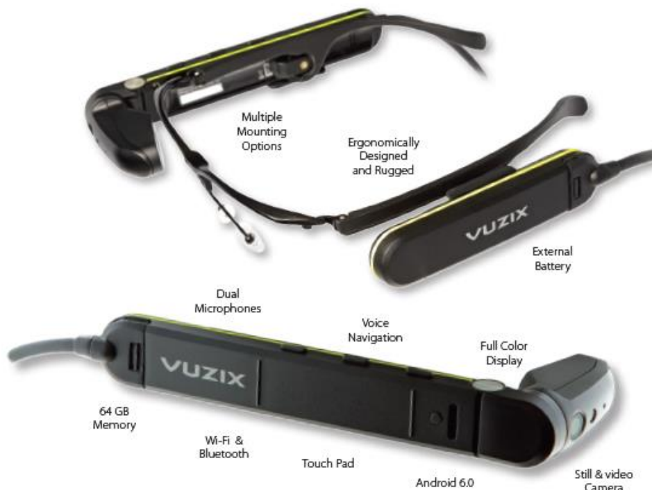
Abbildung 4 - technische Spezifikationen Vuzix M300 Quelle: (Vuzix Corporation, 2018)
