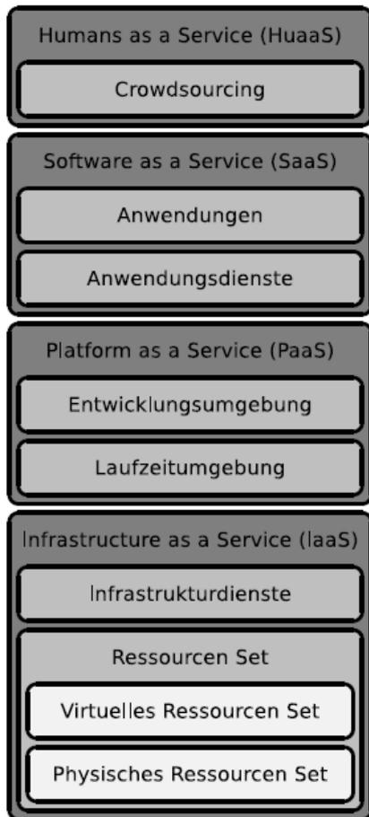
Abbildung 4 - Cloud-Architektur Schichtenmodell [Bau11, S. 30]
